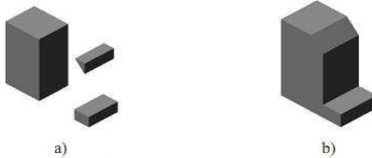
Hình 1.3 : Biểu diễn CSG: a) Các khối cơ bản, b) Mô hình kết quả
